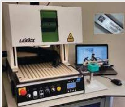
Abb. 2: Handarbeitsplatz für das Direct Part Marking (DPM)
