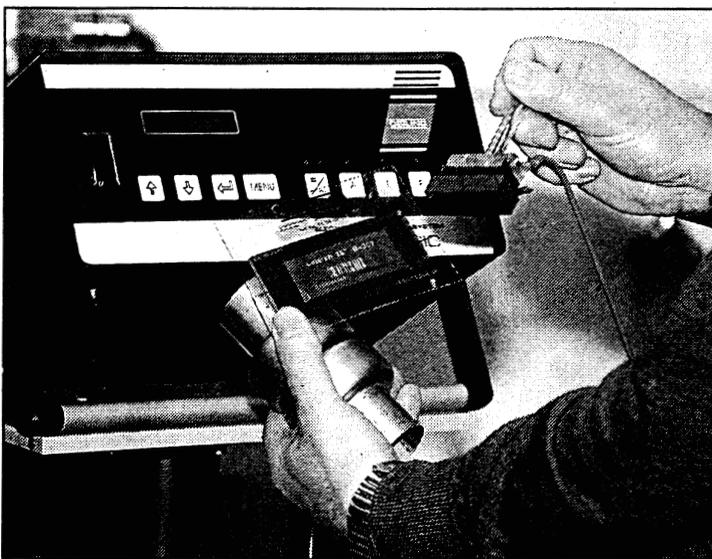
Bei dem neuen elektrolytischen Verfahren wird der Strichcode per Schablone und Stempel auf das stählerne Werkstück gebracht. Unser Bild zeigt eine kleine mobile Anlage. Foto: Christian Beier
