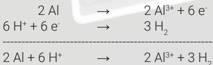
Die gebildeten Aluminiumionen reagieren mit dem im Elektrolyt enthaltenen Wasser zu Aluminiumoxid:
